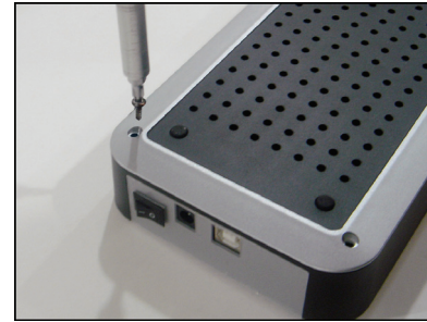
7. Используйте винты (2 коротких) снизу корпуса накопителя для крепления крышки
